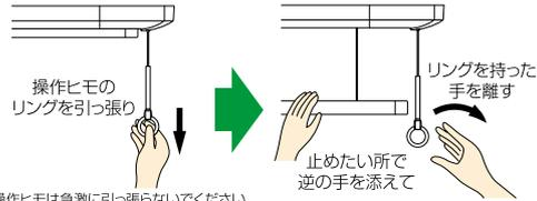
※操作ヒモは急激に引っ張らないでください。故障や誤作動の原因となります。 ※操作時は内部部品が動くため音が発生します。
