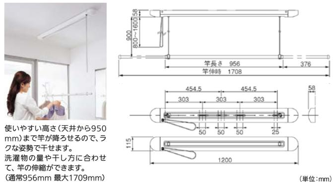
使いやすい高さ(天井から950mm)まで竿が降ろせるので、ラクな姿勢で干せます。洗濯物の量や干し方に合わせて、竿の伸縮ができます。(通常956mm 最大1709mm)
